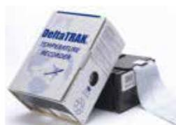
Adquisidor de datos un solo uso. Muy adecuado para transporte. Gráfica de hasta 30 días. Rango: - 29 °C a 38 °C.
