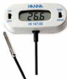
Termómetro con sonda de 1 m de cable y dorsal magnético. Rango: -50 a +150 °C.
