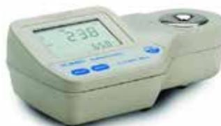
Determinación contenido en azúcar. Compensación automática de temperatura. Rango: 0 a 85 °Br.
