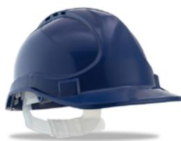
Casco en polipropileno alta densidad. Arnés interior 4 puntos de anclaje. Ranuras laterales para orejeras o visor y orificios laterales para barbiquejo con mentonera (opcional). Normativa: EN 397. Colores: Blanco, azul y amarillo.
