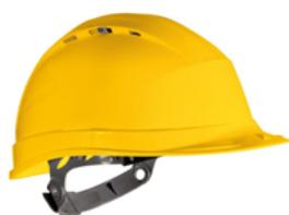
Casco de obra ventilado en polipropileno de alta densidad. Arnés interior de 8 puntos de fijación. Normativa: EN 397. Colores: Blanco, azul y amarillo.
