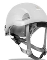
Casco fabricado en ABS para trabajo en altura. Ajuste mediante ruleta tipo roller. Arnés interior con 4 puntos de anclaje. Ranura lateral para orejeras o visor y barbiquejo con mentonera. Normativa: EN 12492. Color: Blanco, azul, amarillo y rojo.
